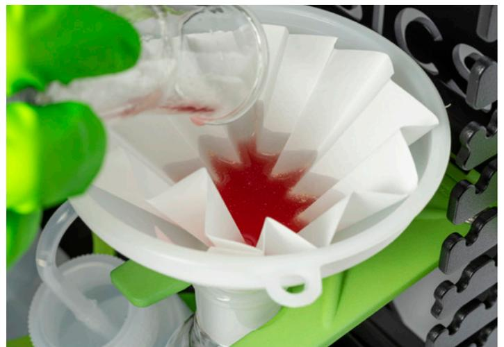
Filtrieren in einem Rundkolben in einem SmartRack® classic
